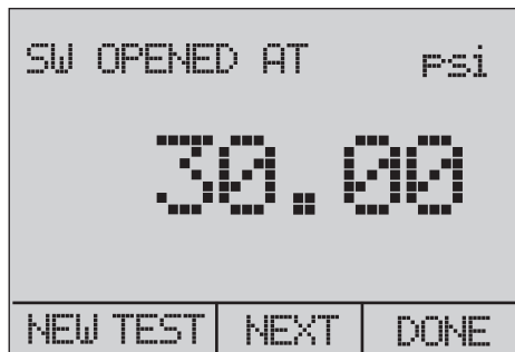
Figura 23. Lectura de conmutador abierto
