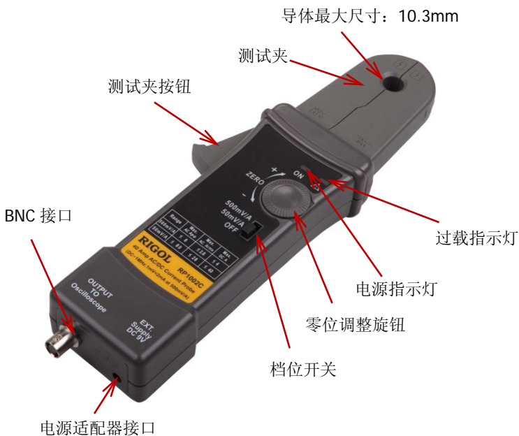
图 1 RP1002C 电流探头
